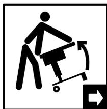
Basculer le pupitre sur les roulettes (env. 10 cm) en se positionnant **côté maître** et le déplacer au nouvel endroit en direction de la flèche depuis la position **abaissée**.
