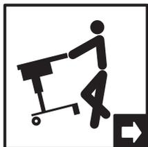
Soulever le pupitre d'env. 10 cm en se positionnant côté élève et le déplacer au nouvel endroit en direction de la flèche depuis la position surélevée.
