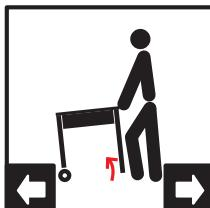
Tisch seitlich ca. 10 cm anheben und in Pfeilrichtung aus erhöhter Position an neuen Ort stossen oder ziehen.
