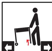
Soulever le pupitre d'environ 10 cm en se positionnant côté élève et le déplacer au nouvel endroit en direction de la flèche depuis la position surélevée.
