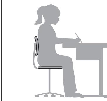
**La hauteur du plateau de table doit** correspondre à la hauteur des coudes de l'utilisateur en position assise, les bras ballants. Compter une largeur de main entre le haut du corps et le pupitre pour obtenir **la distance optimale**.
