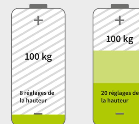
Avec une charge de 100 kg, il est possible de procéder à 8 réglages de la hauteur avec la batterie plomb-gel, contre 20 réglages avec la batterie lithium-ion.
