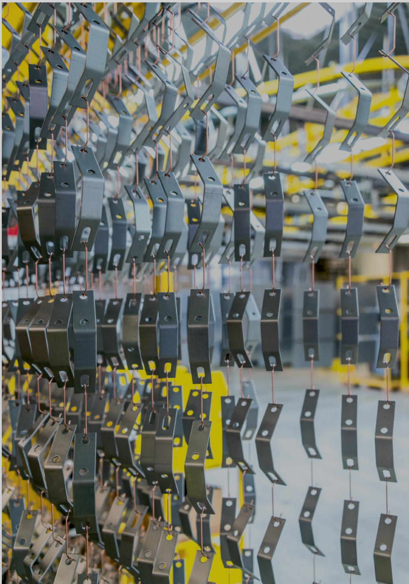
Embru-Werke Pulverbeschichtungsanlage in Rüti (ZH)
